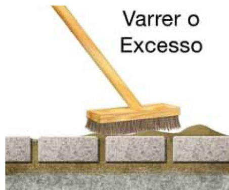
pavimento. Por isso, é importante empregar o material adequado e executar a selagem o melhor possível, simultaneamente com a compactação final do pavimento. Se as juntas estiverem mal seladas, os blocos de concreto ficarão soltos, o pavimento perderá intertravamento e se deteriorará rapidamente. Isso se aplica tanto a pavimentos recém-construídos quanto a antigos.
