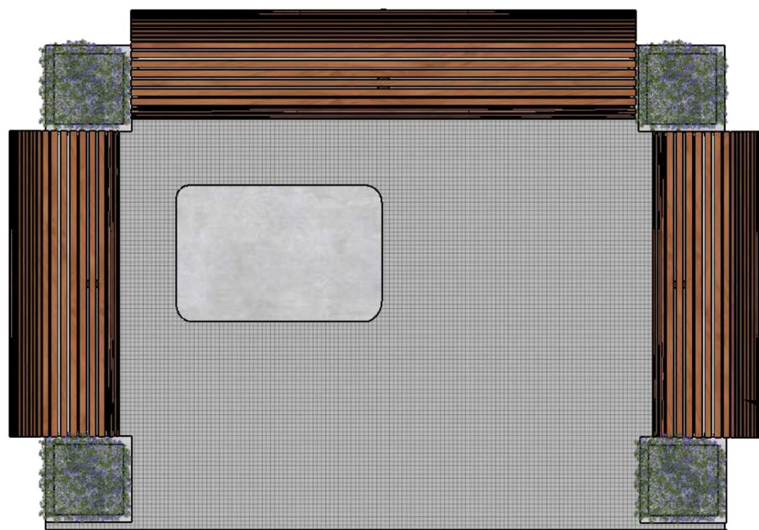
• piso em ladrilho hidráulico quadriculado, sobre contrapiso de concreto
